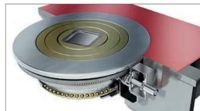
Der Drehtisch ist das klassische Aggregat für die Bereitstellung der Drehkraft zum Drehen des Bohrstrangs. Wenn die Bohrung unterbrochen wird, kann er
