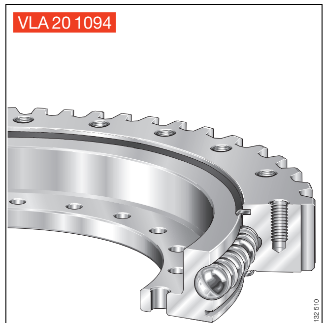
Bild 1 · Kurzzeichen – Beispiel Vierpunktlager
