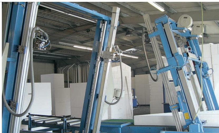
Le cadre de coupe est constitué de deux modules linéaires INA MKUVE20-B-ZR, ayant chacun un système de préhension et neuf unités unifilaires
