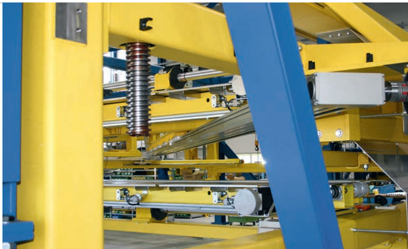
Un module en tandem MDKUSE25-3ZR assure la manutention précise des pièces métalliques du cœur de transformation des feuilles de la position longitudinale à une position transversale
