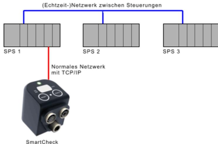
Die Daten vom Schaeffler SmartCheck bzw. ProLink Gerät werden dann von SPS 1 über das Echtzeitnetzwerk an SPS 3 weitergeleitet.
