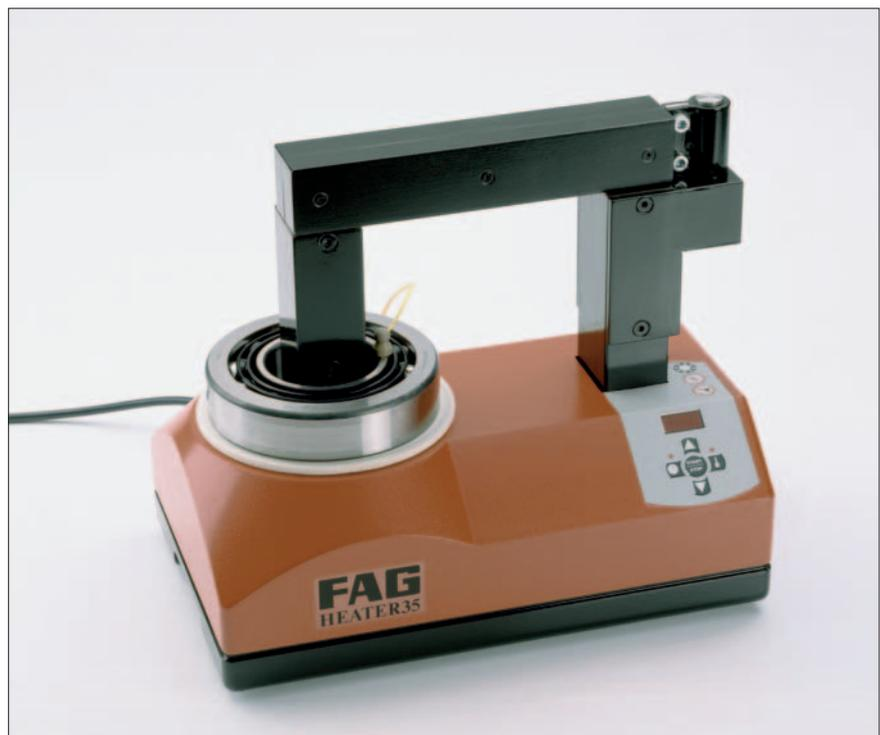
Induktives FAG Anwärmgerät
