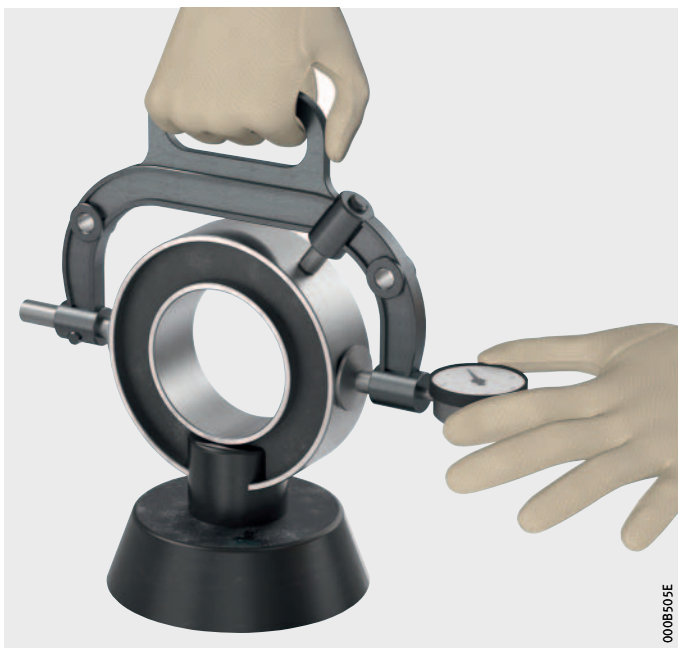
Figure 10 Réglage du micromètre extérieur sur la bague-étalon
