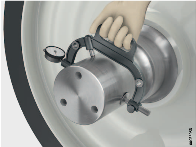
Figure 11 Mesurer la portée de l'arbre avec un micromètre extérieur
