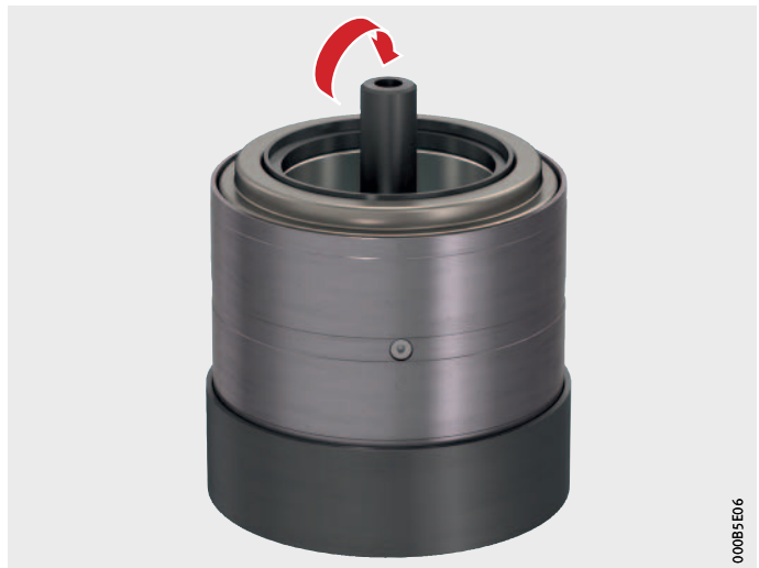
Figure 18 Unité TAROL avec outil d'extraction dans bague de réception et poinçon avec plaque porte-poinçon
