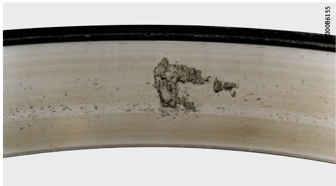
Figure 3 Dommages dus à la fatigue
