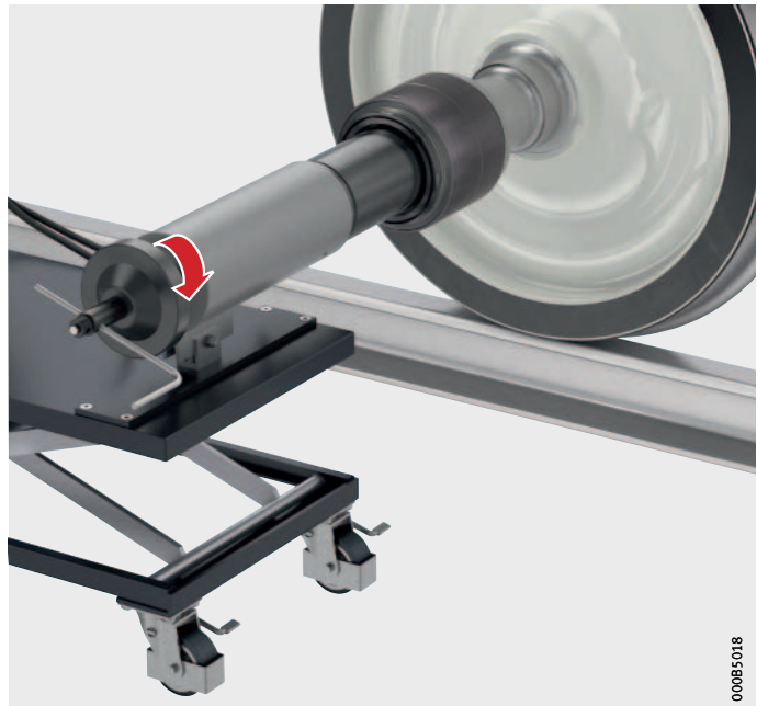
Figure 6 Visser la broche dans la douille de guidage
