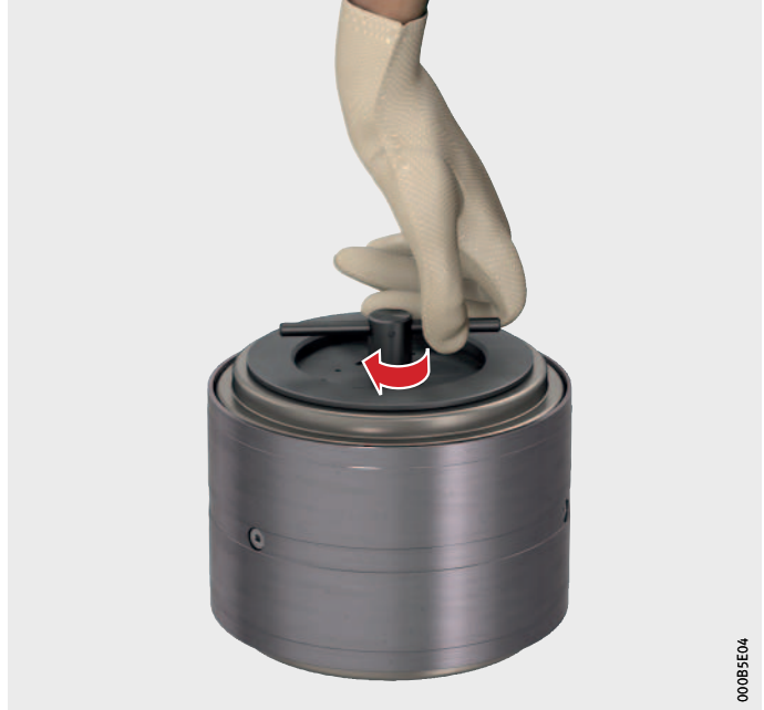
Figure 17 Placer l'outil d'extraction sur l'unité TAROL et serrer
