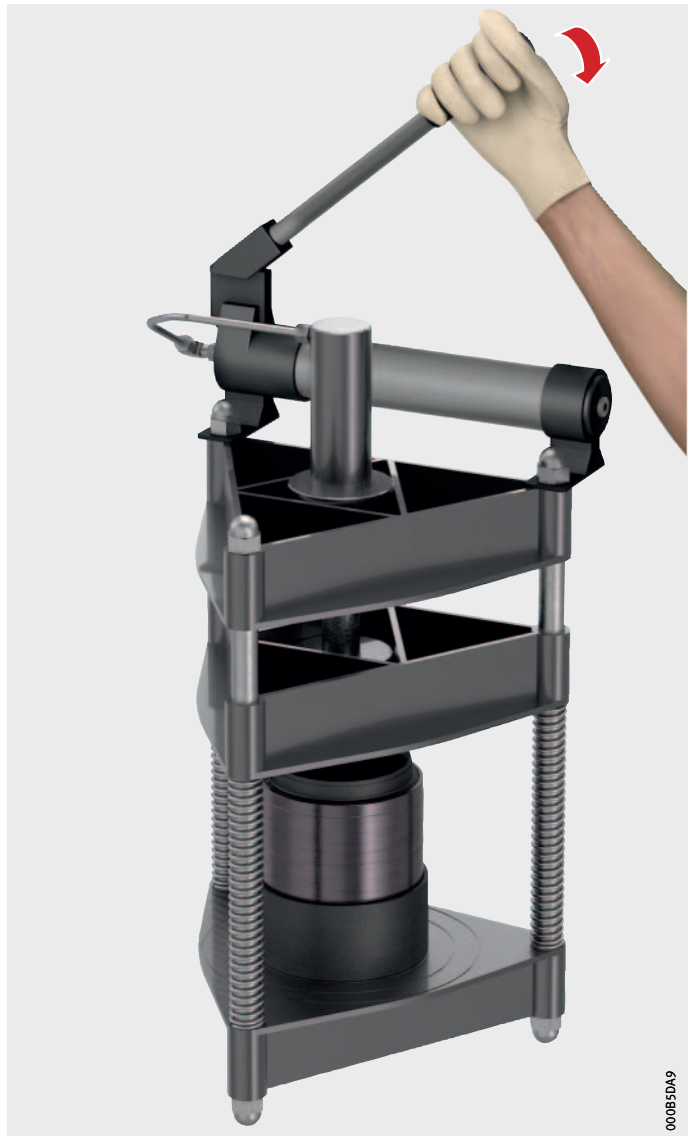
Figure 14 Mettre en place et aligner les roulements dans la presse ; actionner la presse
