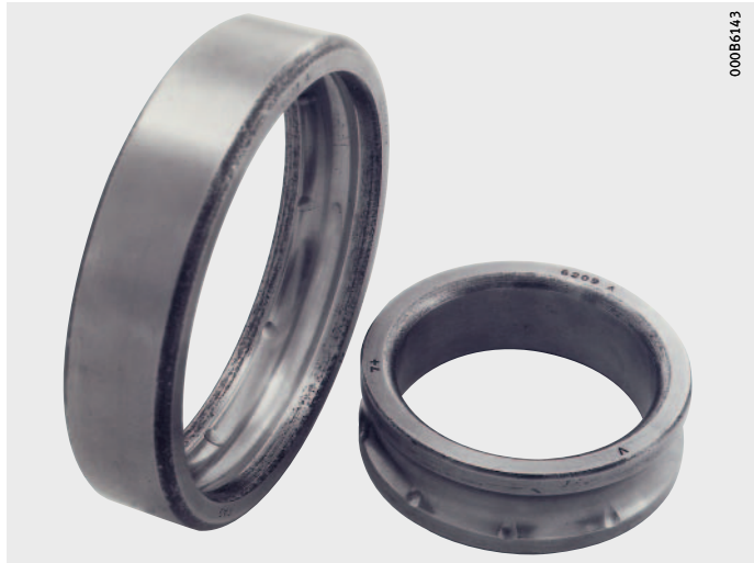
Figure 2 Empreintes des éléments roulants (Brinelling)
