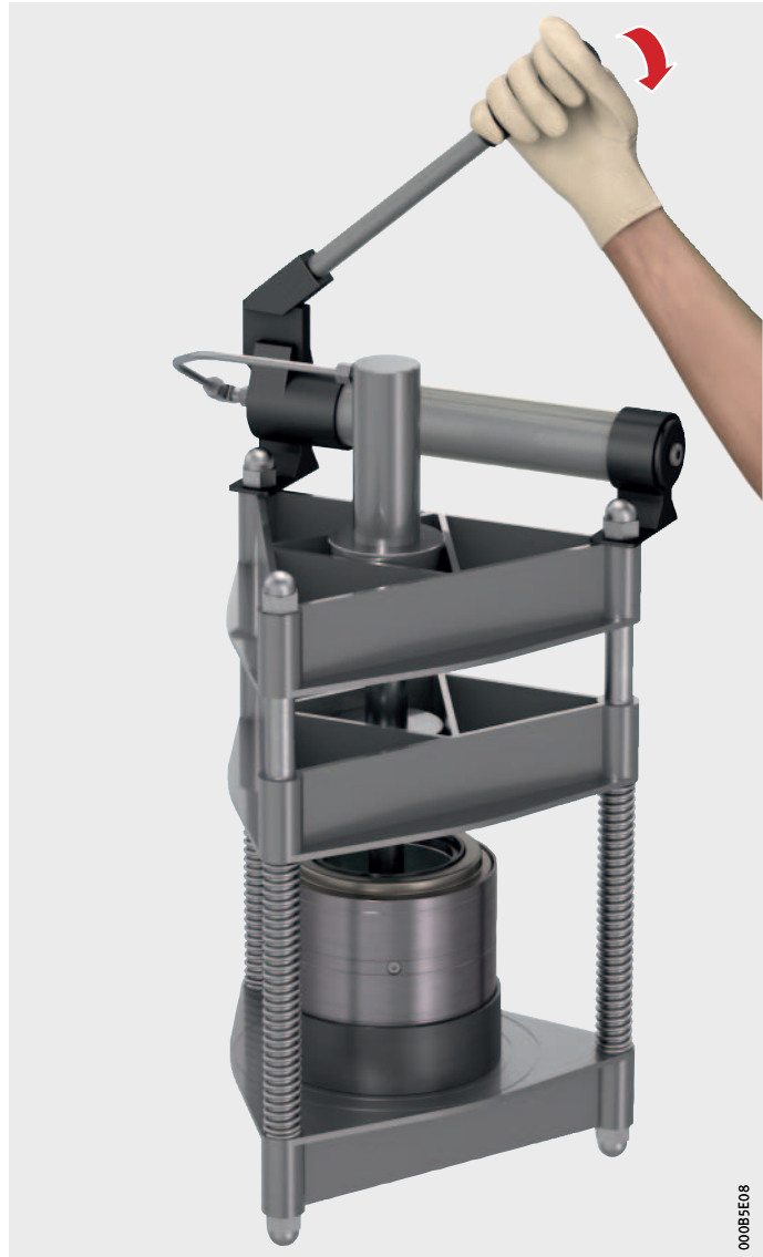
Figure 19 Placer l'unité TAROL dans la presse à plaques, l'aligner et actionner la presse
