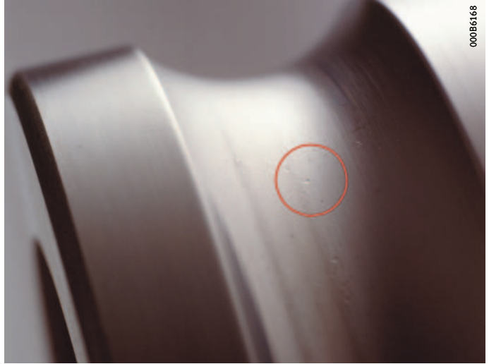
Figure 4 Empreintes sur les chemins de roulement dues à l'encrassement
